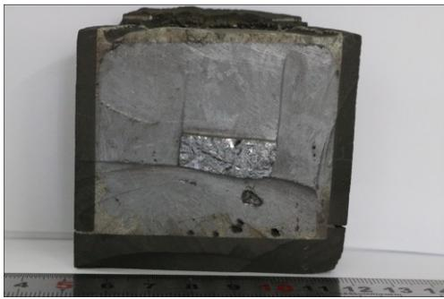
Fig. 2 Longitudinal section of silicon ingot
