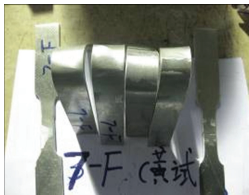
图 7 焊接接头拉伸与弯曲测试
