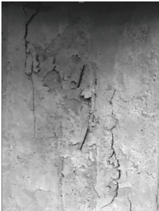
图 8 非贯通破坏示意图 Fig. 8 Schematic diagram of un-coalescence failure mode
