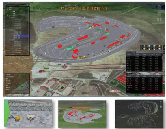
图 28 三维露天矿卡车调度系统<sup>[44]</sup>
