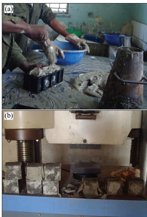
图 7 充填体强度实验
