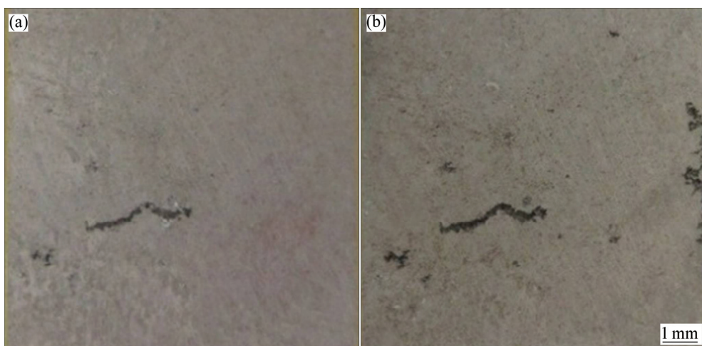
图 4 合金 3 经历干湿循环腐蚀后的腐蚀形貌
