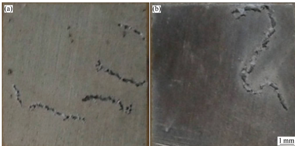
图 5 合金 3 连续浸泡腐蚀环境与干湿交替腐蚀环境腐蚀形貌
