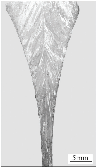
图 1 熔池的宏观组织 Fig. 1 Macrostructure of molten pool
