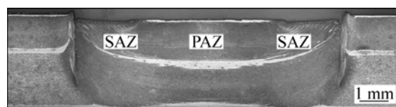
图 8 FSpW 焊点横截面的宏观形貌
