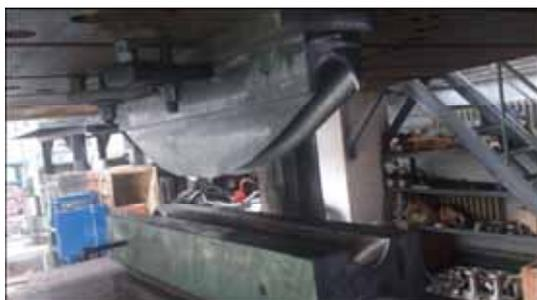
图 3 压弯模具照片
