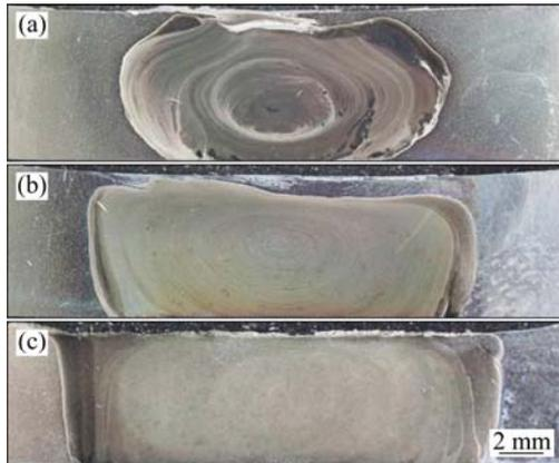
图 4 复合材料横截面宏观形貌
