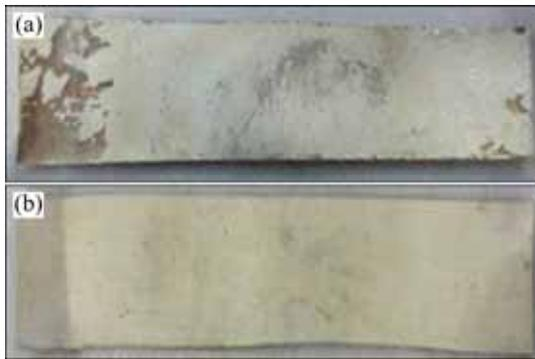
图3 两种粗化方法制备的Ag-IPMC样件
