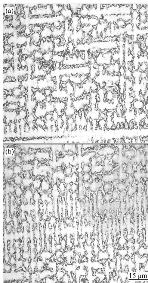
图 1 铸态 CoCrFeNiTi 0.5 高熵合金在喷涂前后的显微组织
