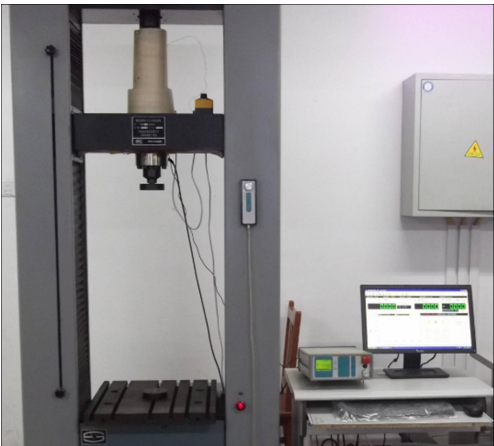
图 1 蠕变试验设备 Fig. 1 Creep test equipment
