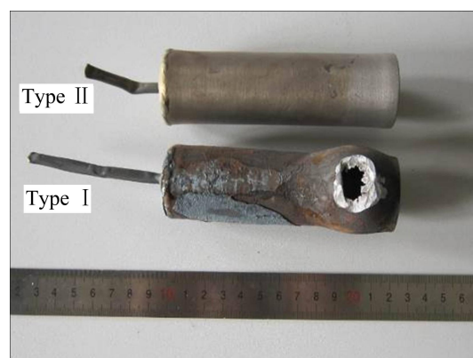
图 6 Ti-60 热处理后包套膨胀照片
