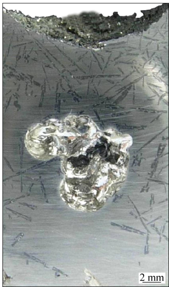
图 4 Si-94%Sn 合金熔析精炼后的剖面图 [17] Fig. 4 Cross-section of Si-94%Sn alloy after solvent refining [17]
