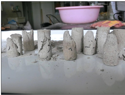
图12 试件单轴受压破坏类型图
