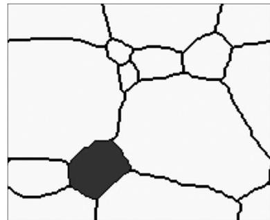
图 3 含沿晶裂纹的母相组织
