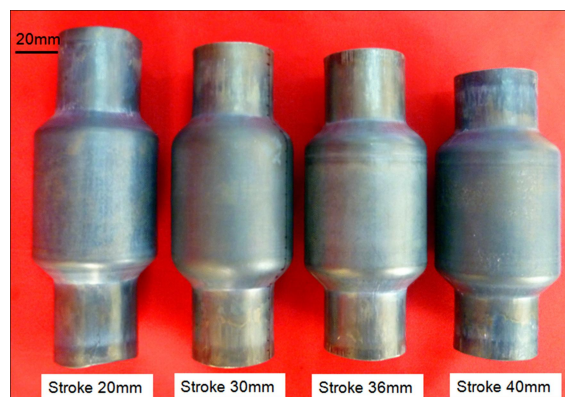
图 10 不同补料量的变径管成形件
