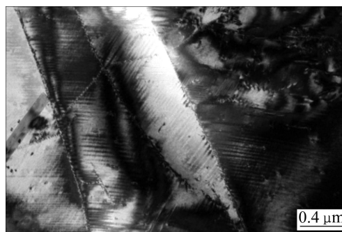
图 4 试样中剪切变形带衍衬像
