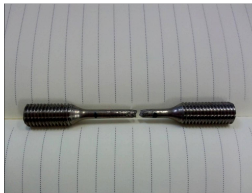
图 2 拉断后样品宏观形貌
