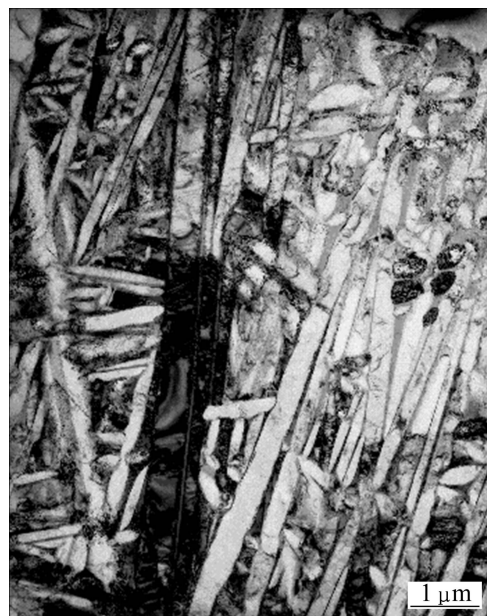
图2 550 °C、20 h去应力退火后Ti6321合金的TEM像
