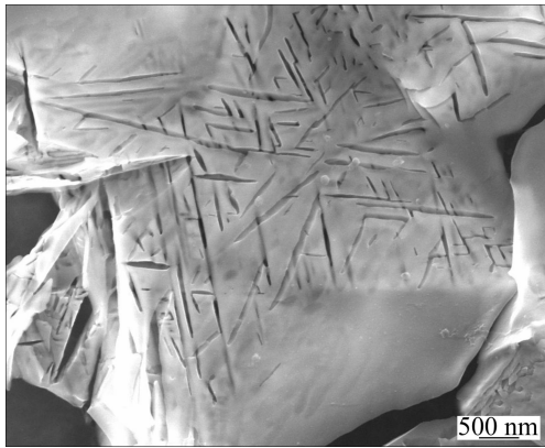
图 3 550 °C、20 h 去应力退火后 Ti6321 合金的扫描电镜观察结果
