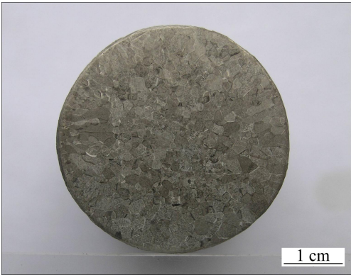
图 3 TA15 铸锭试样低倍组织 Fig.3 Macrostructure of TA15 ingot
