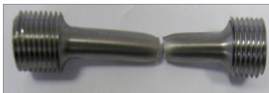
图 6 扩散焊接头拉伸断裂试样照片
