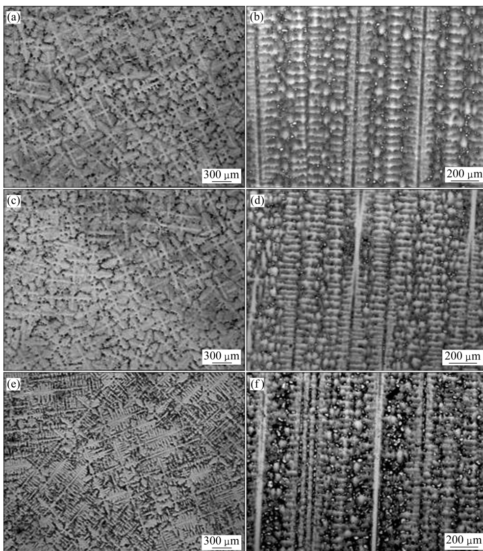
图 1 不同抽拉速率下 DZ483 合金横向及纵向的显微组织
