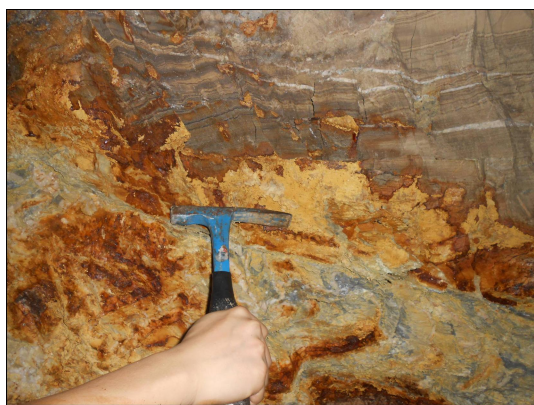
图 9 沃溪坑口 V8 号矿脉(沿裂隙充填, 明显切过板理, 并包裹围岩角砾)
