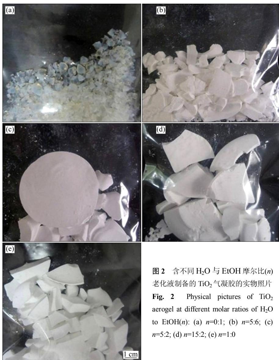
图 2 含不同  $\text{H}_2\text{O}$  与  $\text{EtOH}$  摩尔比( $n$ )老化液制备的  $\text{TiO}_2$  气凝胶的实物照片
