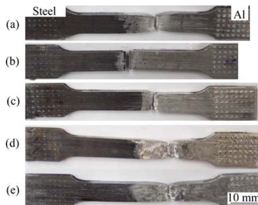
Fig. 3 Fracture locations of welds: (a) S1; (b) S2; (c) S3; (d) S4; (e) S5
