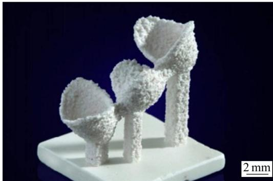
图 10 采用 SLM 技术制备的  $\text{Al}_2\text{O}_3\text{-ZrO}_2$  陶瓷牙齿支架模型照片<sup>[23]</sup>
