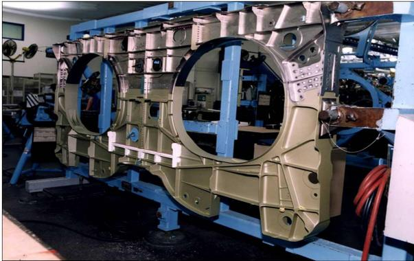
图4 采用 LENS 技术制造的飞机外挂架舱壁照片
